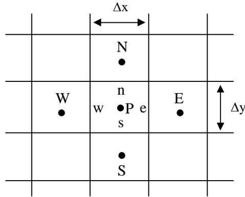
Figura: 8.4: Malha 2D uniforme em cada direção
