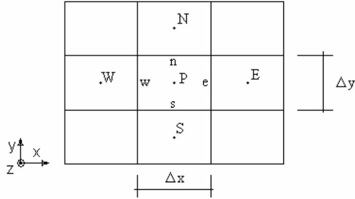
Figura 8.2: Malha 2D uniforme por direção
