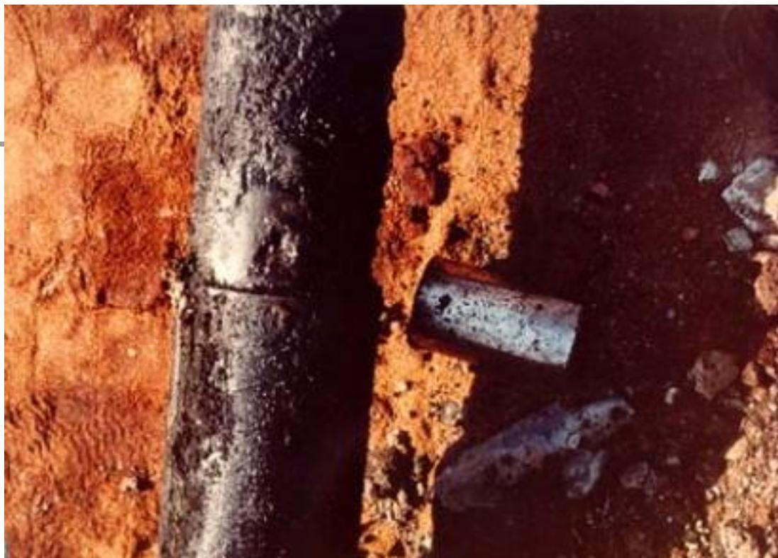
**Figura 7- Corrosão localizada causada pelo solo**
