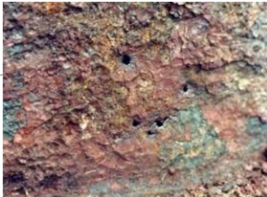
**Figura 9- Corrosão localizada e generalizada em duto de petróleo enterrado**
