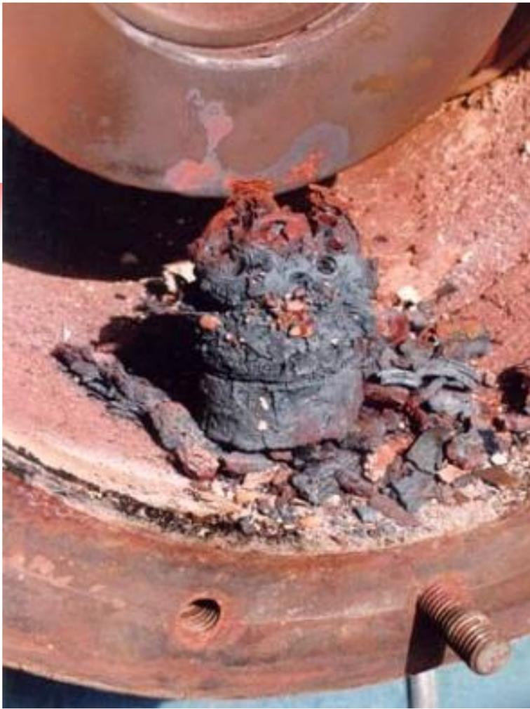
**Figura 4- Corrosão por alta temp. em bico queimador**
