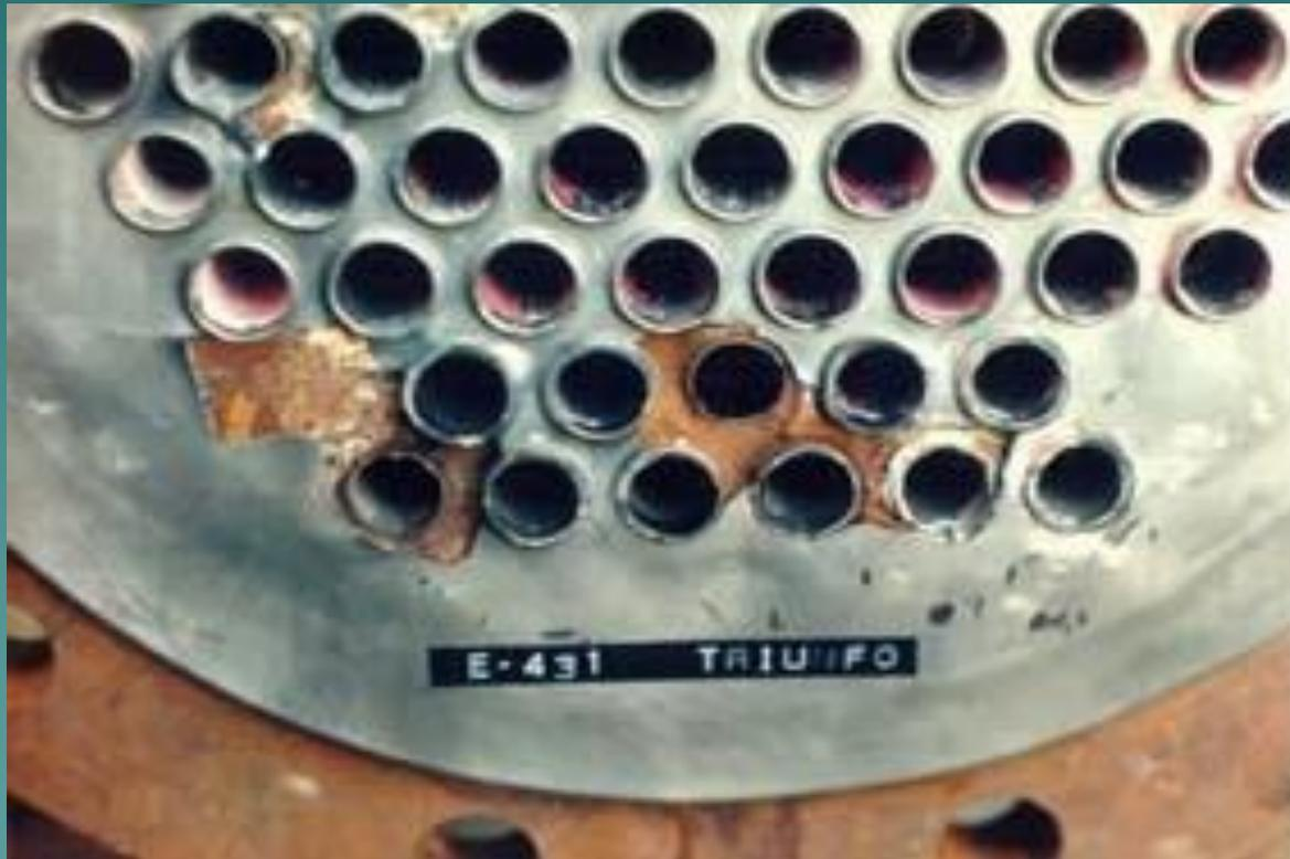
Fig. 11- Corrosão por Par Galvânico em Feixe - Espelho de Permutador de Calor
