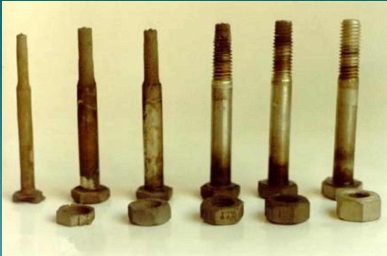
**Fig.15- Corrosão Por Fresta em Parafuso-Porca**
