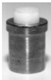
**Figura 10.** Adaptador para pino de diâmetro 10 mm
