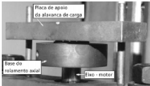
**Figura 6.** Ponta superior do eixo – motor com a base do rolamento axial e placa de apoio da alavanca de aplicação de carga
