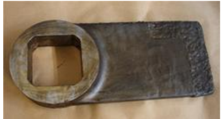
Revestimento de pá de misturador
