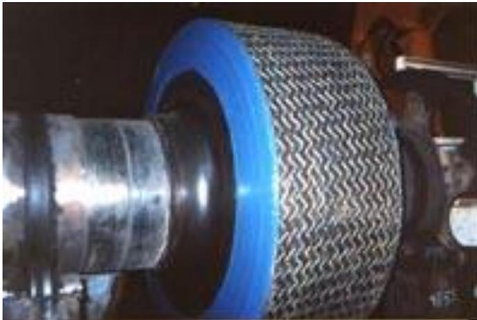
Revestimento rotor hidrapulper
