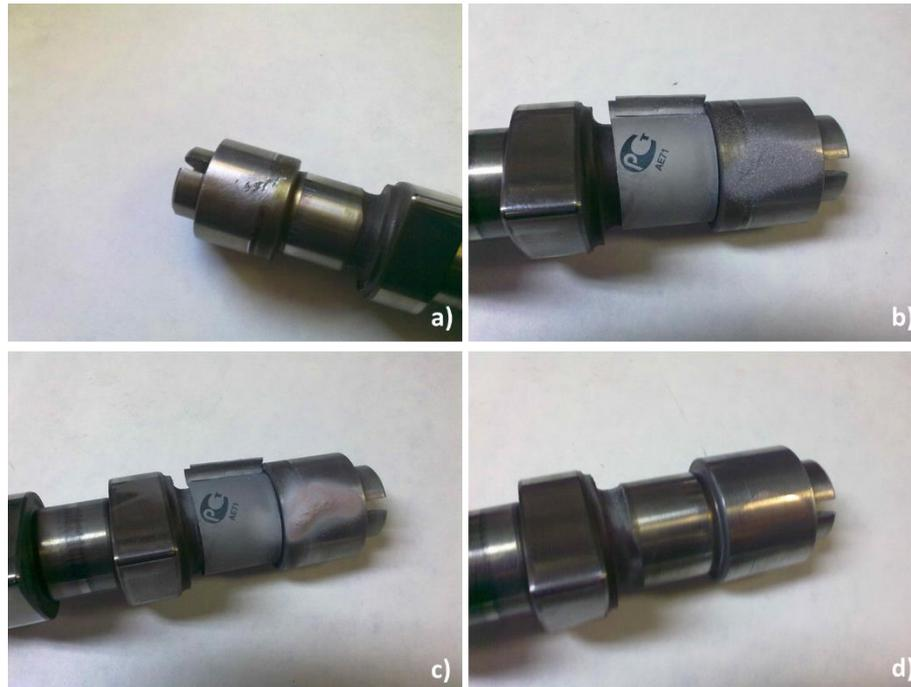
FIGURA 53 – RECUPERAÇÃO DE UMA ÁRVORE DE CAMES a) DEFEITO; b) ASPECTO APÓS JATO DE ABRASIVO; c) PÓ A BASE DE COBRE E ZINCO DEPOSITADO SOBRE O DEFEITO VIA *COLD SPRAY*; d) PEÇA RECUPERADA APÓS *COLD SPRAY* SEGUIDO DE TORNEAMENTO E ESMERILHAMENTO
