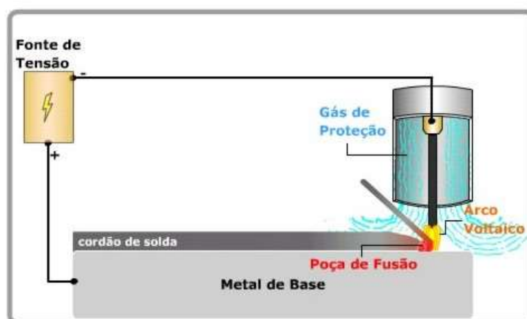
Figura 87 – Ponta da tocha do processo de soldagem TIG [25].
