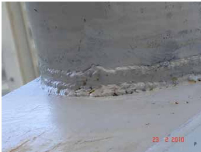
Juntas com perfil irregular, mordedura, inclusão de escória e porosidade.
