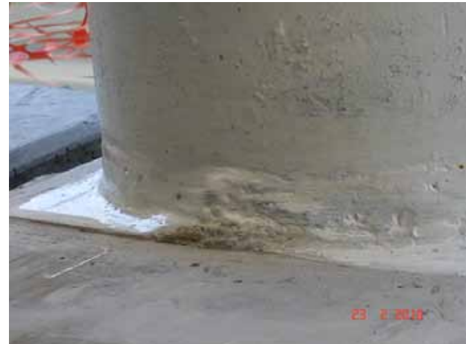
Juntas com perfil irregular, mordedura, inclusão de escória e porosidade.
