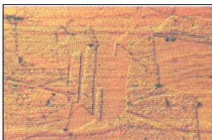
**Figura 1** Microestrutura austenítica de um aço inoxidável. Microscopia ótica. Ataque eletrolítico com ácido oxálico.
