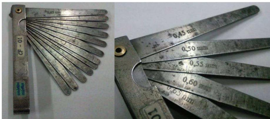
Figura 14 – Canivete de medição de folgas.
