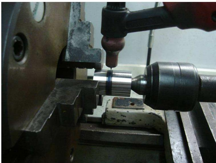
Figura 12 – Solda radial dos corpos de prova.
