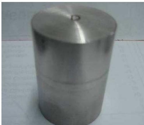
Figura 42 – Aspecto obtido da junta soldada.
