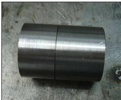
Figura 10 – Montagem das peças para a solda.
