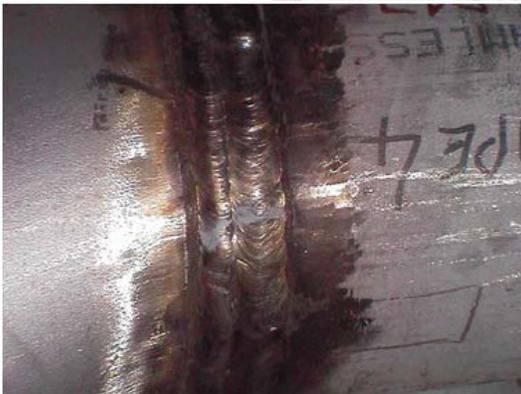
*Peça de aço inoxidável soldada na condição "como soldada": a incrustação de óxido provavelmente dará caminho à corrosão se não removida adequadamente.*
