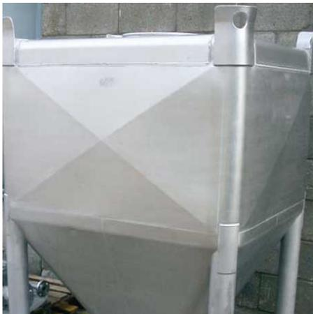
*Após tratamentos de limpeza, decapagem e passivação um acabamento perfeito e consistente é produzido. A aparência é boa e oferece uma superfície com ótima resistência à corrosão para a classe particular de aço inoxidável utilizado.*
