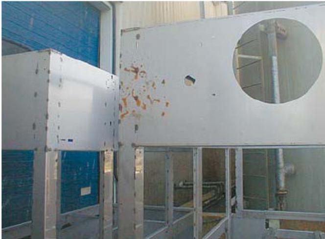
*Contaminação de aço inoxidável por ferro: o exemplo mostrado é um caso típico de contaminação por ferro causada pelo uso misturado de ferro (ou aço) e aço inoxidável na mesma fábrica sem segregação de materiais apropriada. No processo de descontaminação, é importante que os traços de ferro sejam realmente removidos e não apenas dispersados.*
