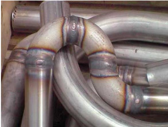
*Incrustação leve deixada nas soldas e coloração por calor nas superfícies dos tubos em conjunto podem geralmente ser removidos por decapagem ácida.*
