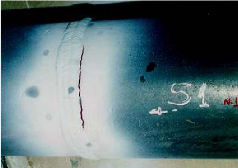
**Figura 3** – “Trinca” de 85 mm constatada por Líquido Penetrante (superfície externa)
