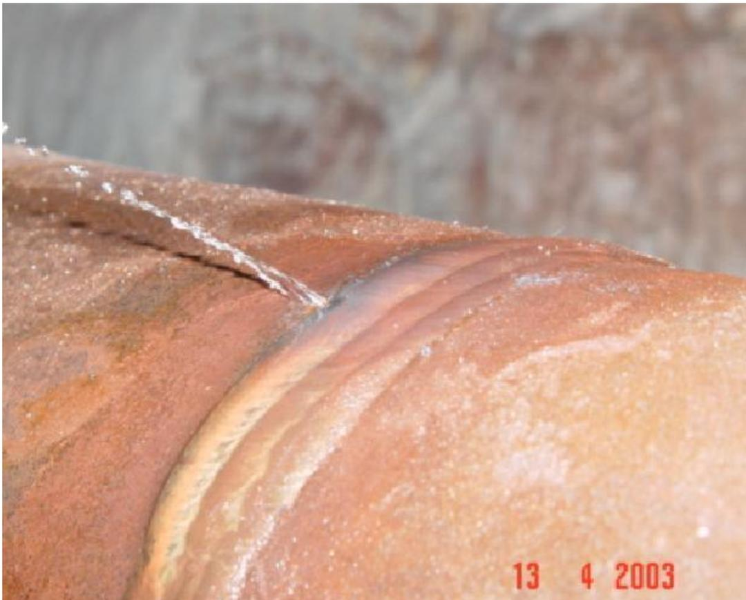
**Figura AP1 03** – Foto em close do Vazamento no Tubo-17 Solda-1
