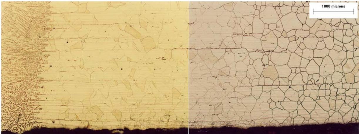
**Figura 44** – TIG Pulsado. Amostra analisada: CP da Seção “C” – Detalhe da Raiz.
