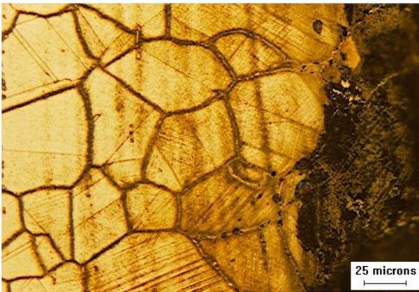
**Figura 8** – Fotomicrografia: detalhe da faixa carburizada e resíduos de coque aderidos.
