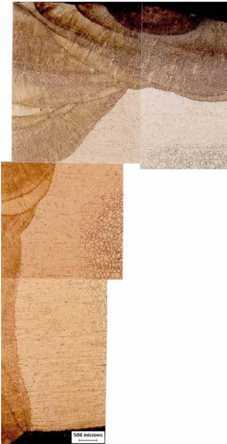
**Figura 25** – Solda: ST-4 (tubo novo X tubo velho). Vista geral da linha de fusão do tubo velho. Amostra analisada: CP - 6
