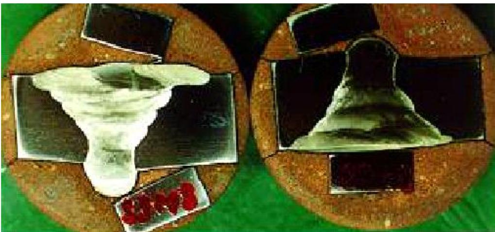
**Figura 5** – Corte transversal da solda mostrando excesso de penetração na raiz.
