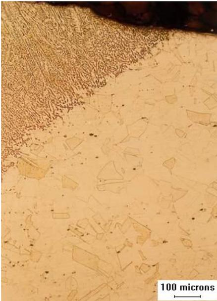
**Figura 29** – Solda: ST-5 (tubo novo X tubo velho). Linha de fusão do tubo novo, próximo à face (superfície externa) da solda. Amostra analisada: CP-7
