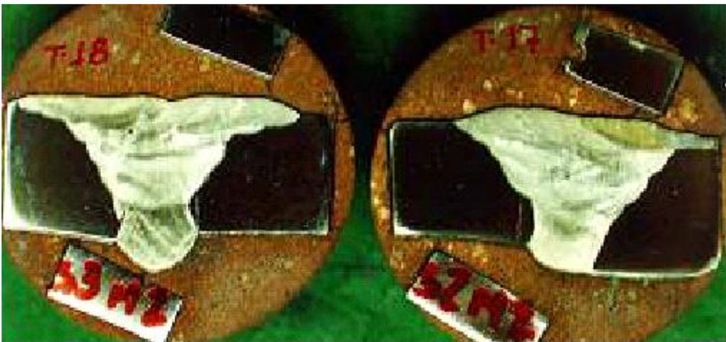
**Figura AP1 07** - Vista de outros 02 CP's metalográficos removidos do Tubo-17 solda S-2 e do Tubo-18 solda S-3
