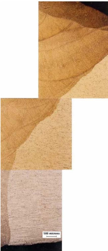
**Figura 28** – Solda: ST-5 (tubo novo X tubo velho). Vista geral da linha de fusão do tubo novo. Amostra analisada: CP-7
