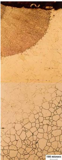
**Figura 26** – Solda: ST-4 (tubo novo X tubo velho). Linha de fusão e ZTA do tubo velho, próximo à face (superfície externa) da solda. Amostra analisada: CP - 6
