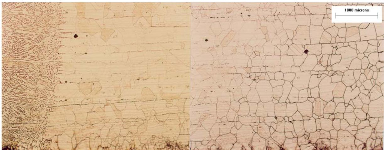
**Figura 45** – TIG Convencional. Amostra analisada: CP da Seção “C” – Detalhe da Raiz.
