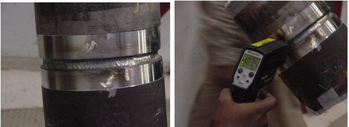
Detalhe de uma camada de enchimento da solda e do acompanhamento de temperatura
