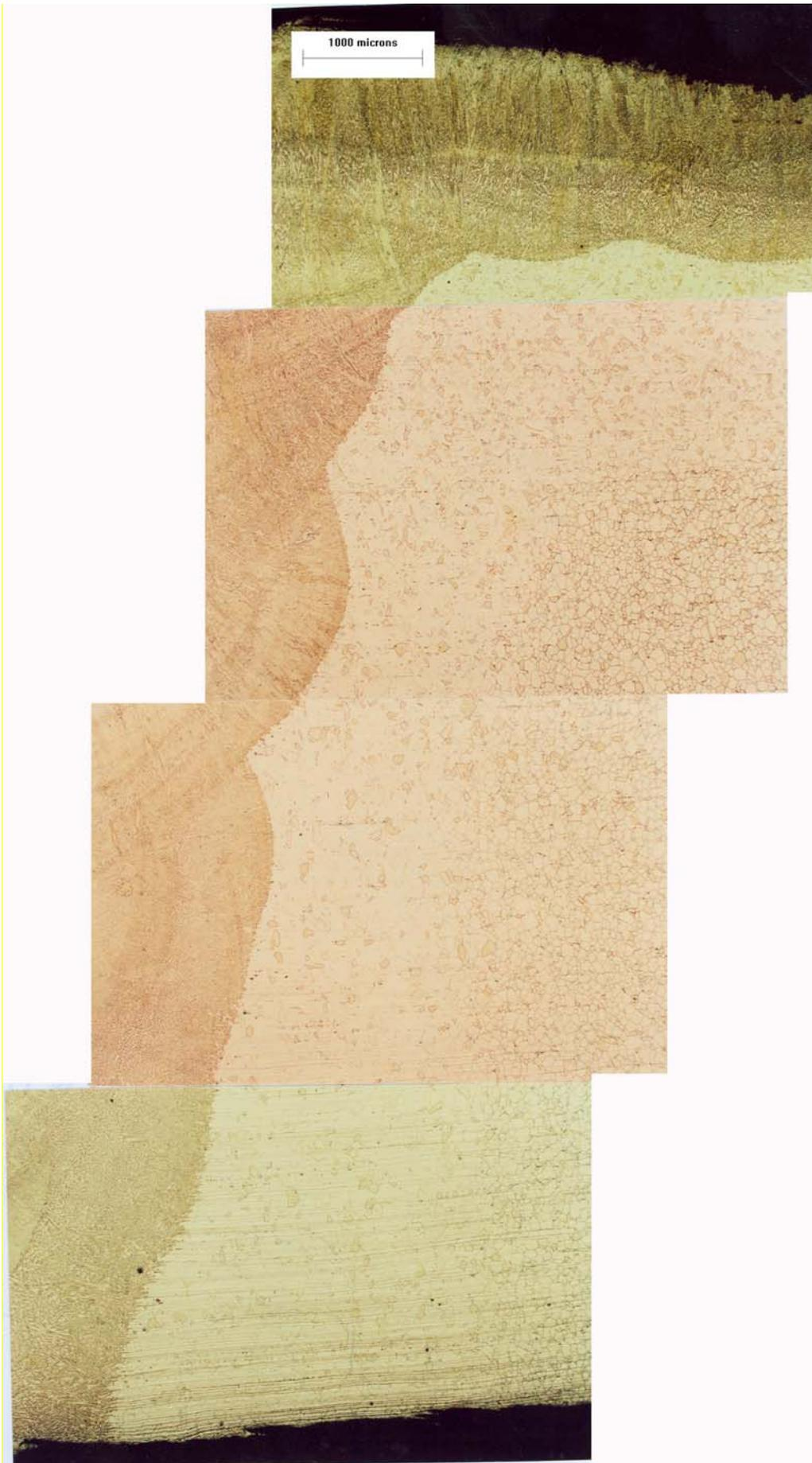
**Figura 37** – TIG Pulsado. Amostra analisada: CP da Seção “A”.
