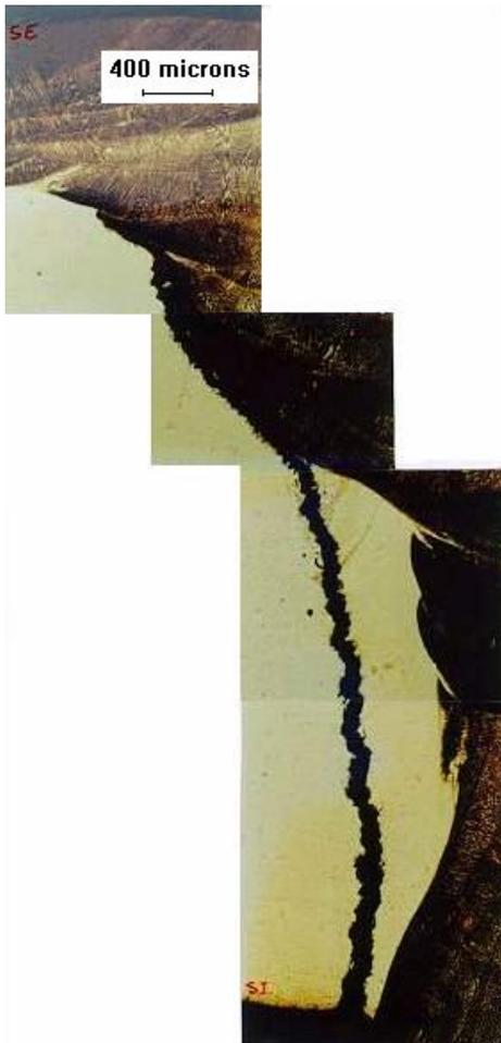
**Figura AP1 09** - Tubo-17, solda S-1, micrografia-1, 45°.
