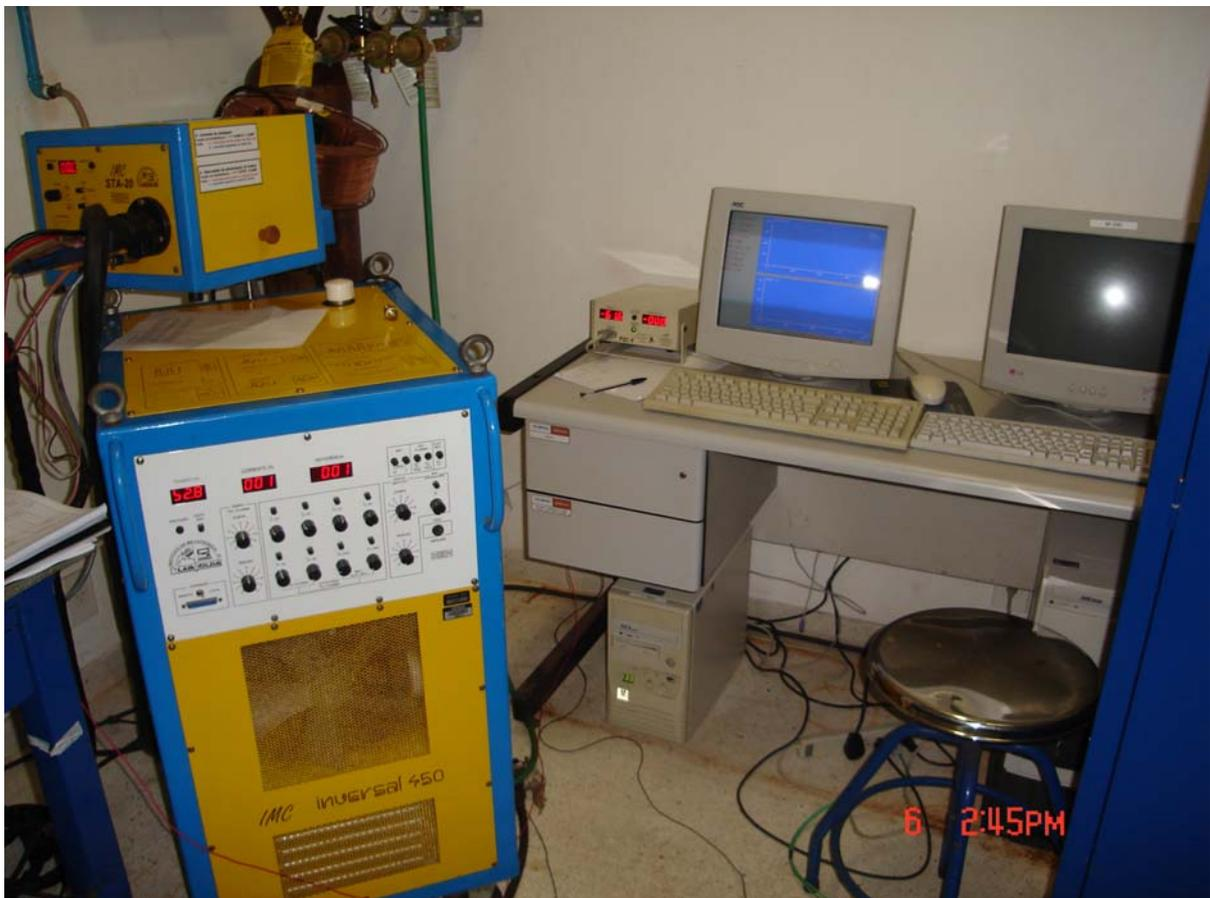
Maquina IMC e o equipamento de monitoramento computadorizado contínuo das soldas
