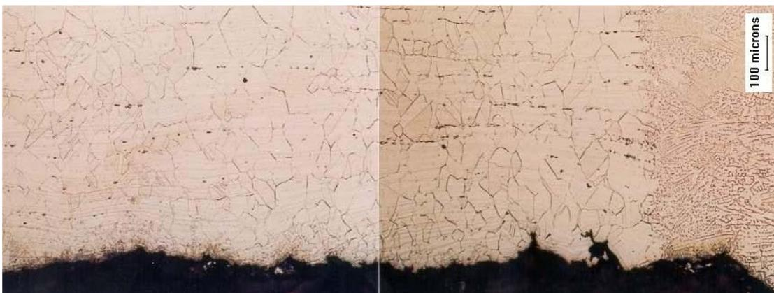
**Figura 30** – Solda: ST-2 (tubo novo X tubo novo). Linha de Fusão, próximo à raiz da solda. Amostra analisada: CP-4
