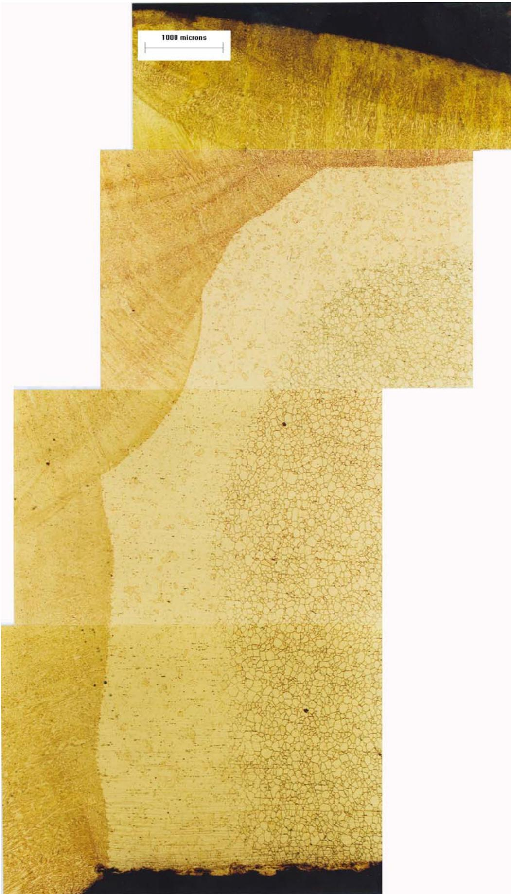
**Figura 43** – TIG Pulsado. Amostra analisada: CP da Seção “D”.
