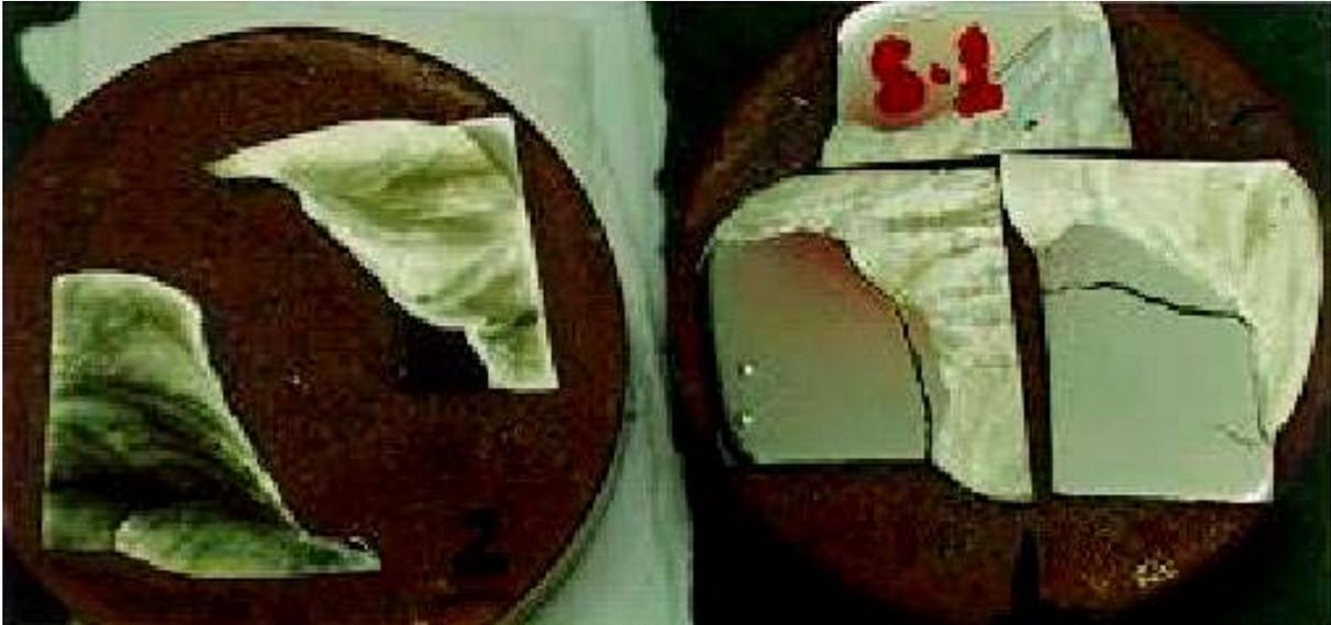
**Figura AP1 05** - Vista de 02 CP's metalográficos removidos na região da trinca passante do tubo-17 solda S-1 (1- extremidade da trinca // 2- região central da trinca).
