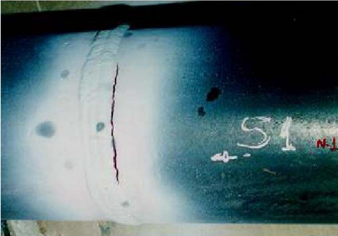
**Figura AP1 04** – “Trinca” de 85 mm constatada por Líquido Penetrante (lado do tubo antigo)
