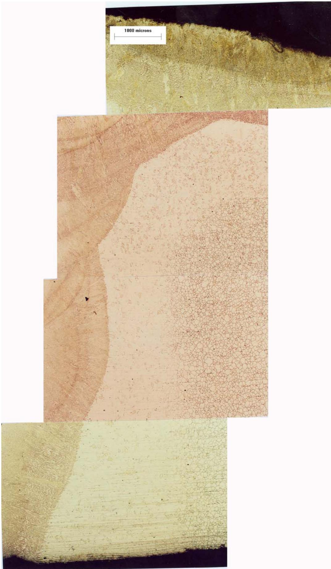
**Figura 39** – TIG Pulsado. Amostra analisada: CP da Seção “B”.
