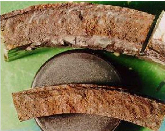
**Figura AP1 06** - Tubo-17 - vista das faces da trinca passante, solda S1
