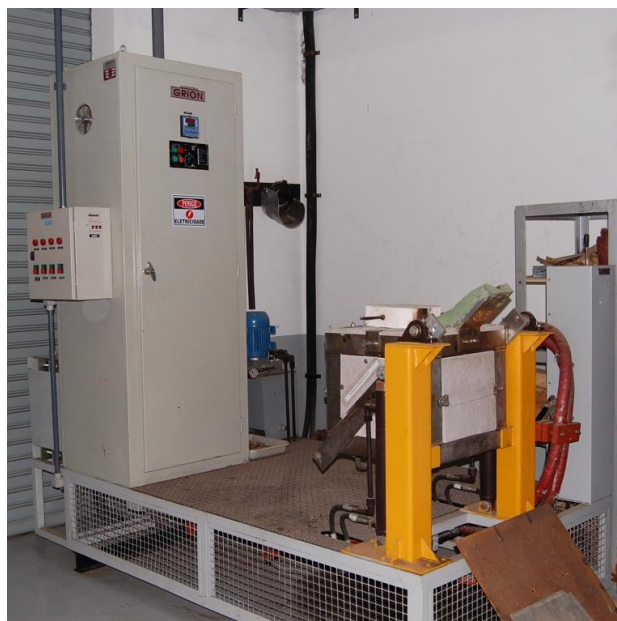
Figura 45: Forno de indução Grion com potência máxima de 35 kW e capacidade de 25 kg.
