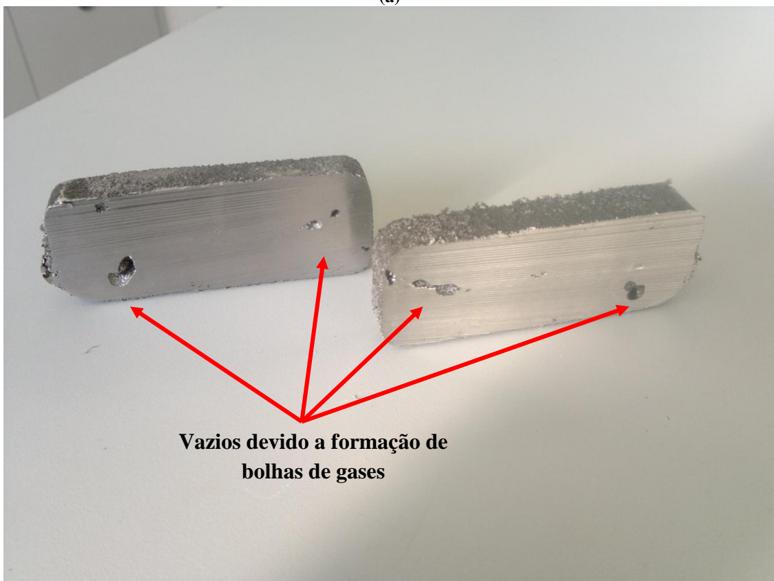
Figura 63: (a) Lingote fundido e maciço até início do massalote. (b) Vazios devido a bolhas de gases provavelmente originados devido à ausência de uma desgaseificação do metal líquido.
