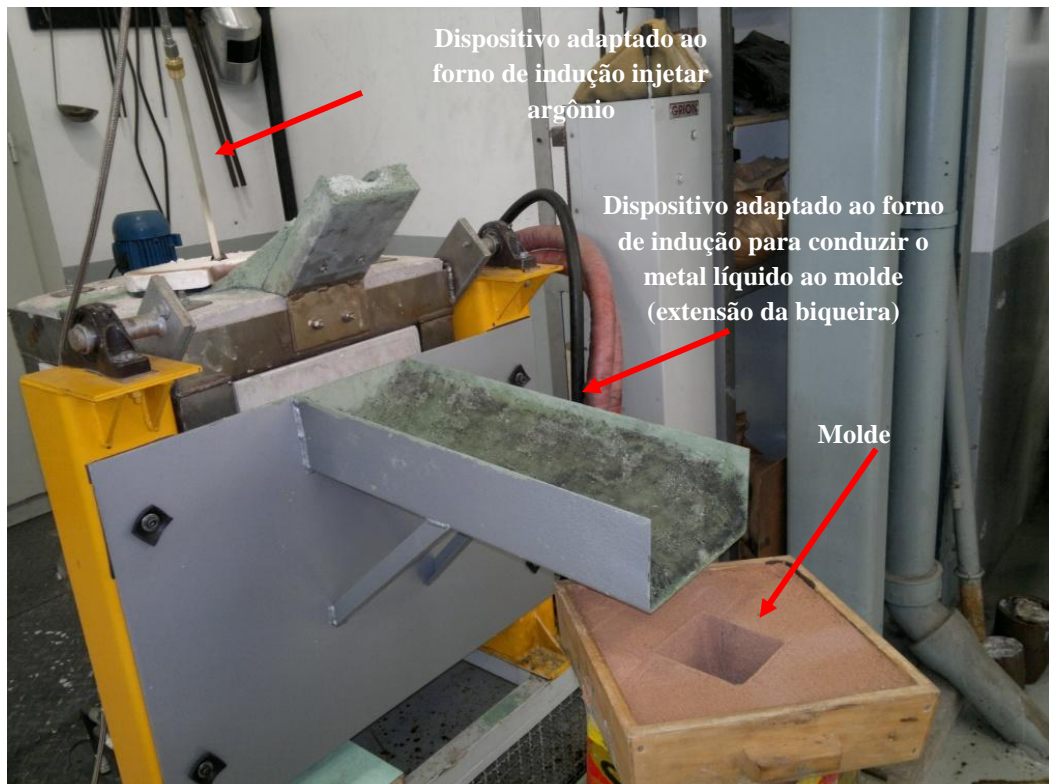
Figura 46: Dispositivos adaptados ao forno de indução
