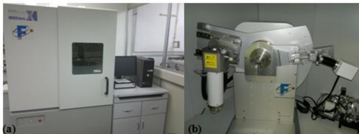
Figura 55: (a) Difratômetro de raios-X acoplado ao sistema computacional; (b) suporte para acoplamento da amostra em estudo.
