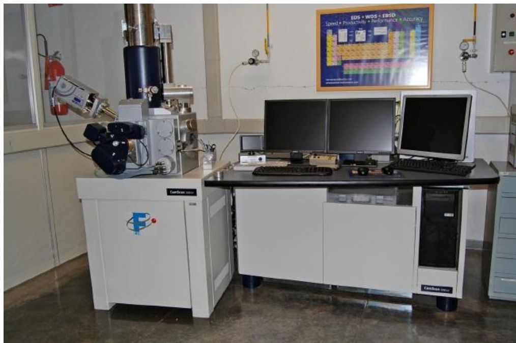
Figura 54: Microscópio eletrônico de varredura modelo CAMSCAN CS3200 com sistema de análise por espectrometria de energia dispersiva (EDS).
