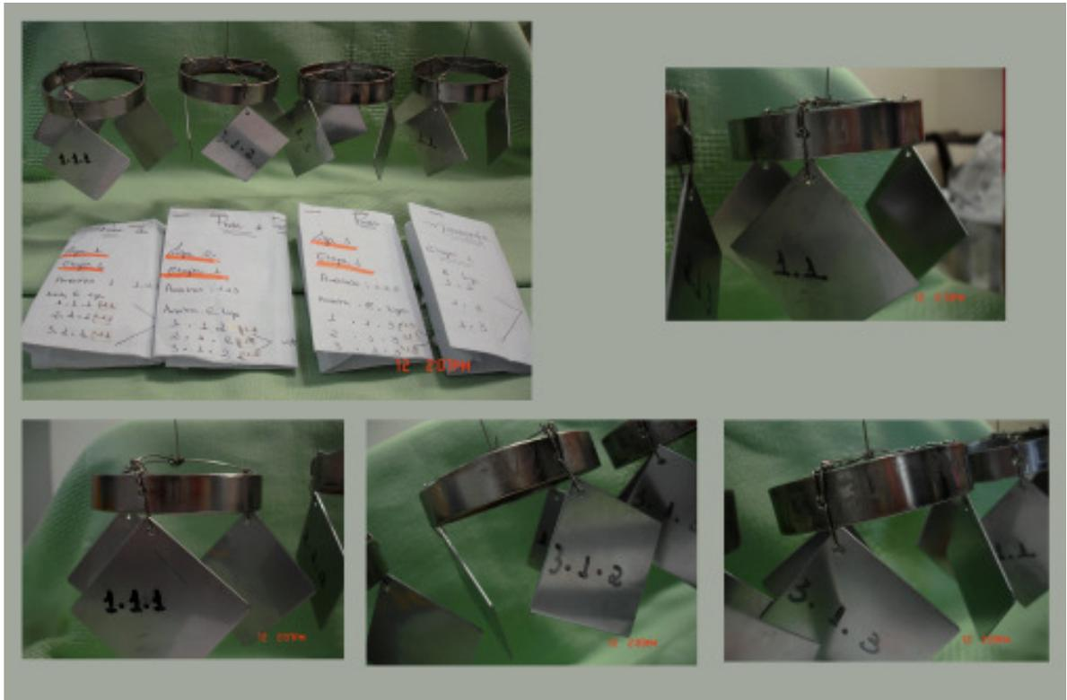
FIGURA 4.1- Fotos das amostras para ensaios de perdas de massas e metalografias.
