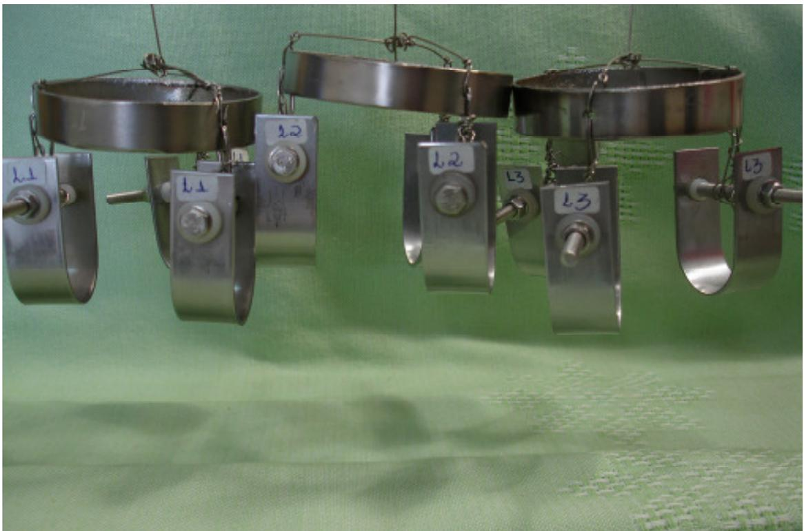
FIGURA 4.2 - Fotos das amostras para ensaios de corrosão sob tensão
