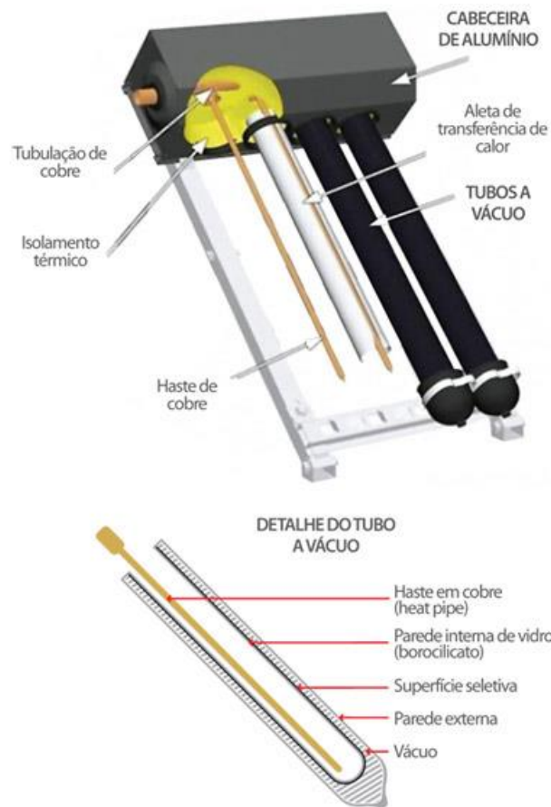
FIGURA 8 – VISTA EM CORTE DE UM COLETOR SOLAR DE TUBO EVACUADO FONTE: COLETOR solar a vácuo. (2015)
