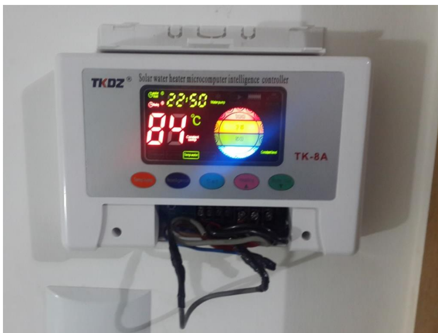
FIGURA 17 – CENTRAL CONTROLADORA QUE FOI UTILIZADA NO EXPERIMENTO PARA OBTENÇÃO DA TEMPERATURA DO RESERVATÓRIO.
