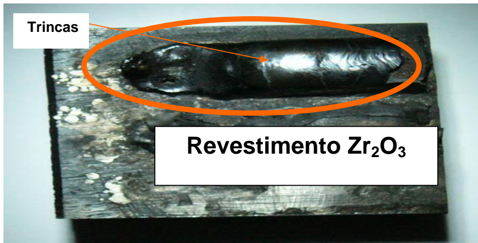
Figura 2. Fotografia do cordão cerâmico aplicado via PTA.
