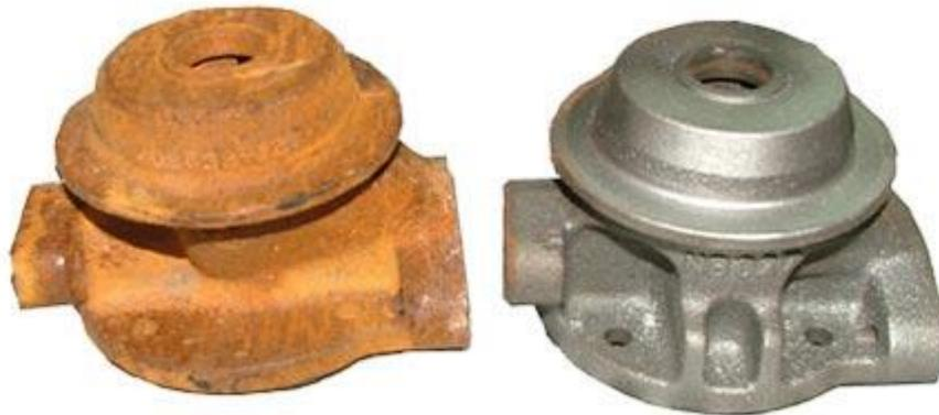
As esferas de vidro estão sempre associadas à formação pouquíssimo pó. Sua forma e dureza oferecem grande resistência à fragmentação. Sua características não abrasivas permitem à BRASIBRAS projetar equipamentos mais elaborados que, contínua e permanentemente, separam as esferas das incrustações removidas e mesmo das esferas quebradas, devolvendo ao processo material limpo e com granulometria similar à inicial.
