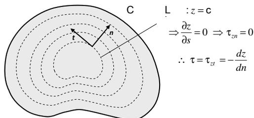
A máxima tensão ocorre no contorno correspondente à máxima inclinação da membrana deformada.
