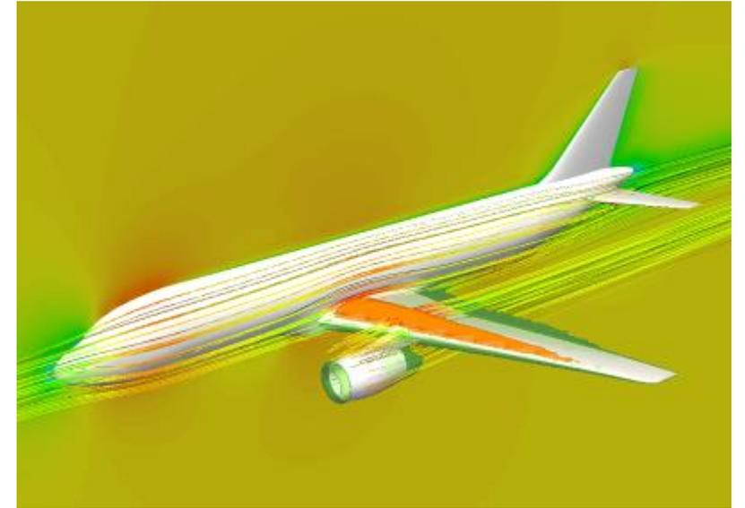
Modelagem de correntes de ar sobre uma aeronave
