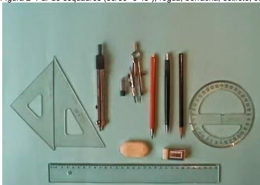
Figura 2- Par de esquadros (30/60° e 45°), régua, borracha, estilete, compasso
