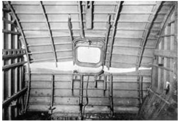
Fig. 7 Ensaio hidrostático à fadiga, após a ruptura.
