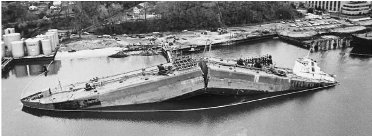
Fig. 5 Navio tanque (Liberty-ship) que fraturou de maneira frágil. (CALLISTER, 2015).
