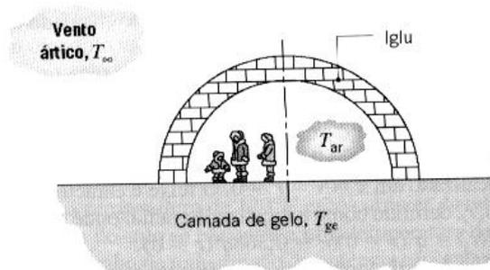
Considerando que os corpos dos ocupantes do iglu forneçam uma fonte contínua de calor de 320 W no interior do iglu, calcule a temperatura do ar no seu interior quando a temperatura do ar externo é de  $T_\infty = -40^\circ\text{C}$ . Certifique-se de levar em consideração as perdas de calor pelo chão do iglu. Resp:  $1,2^\circ\text{C}$ .
