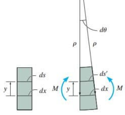
A curvatura de um eixo sujeito a um momento fletor M é dada por:
