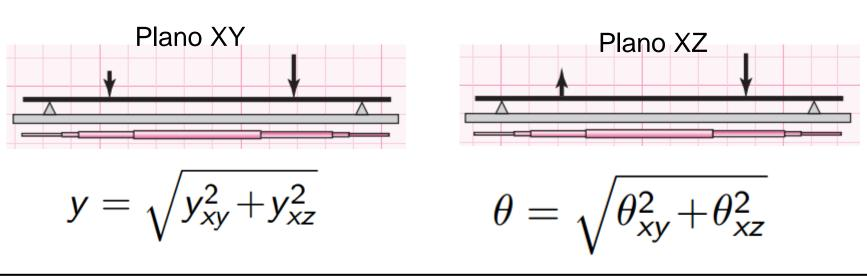
Caso algum diâmetro necessite ser alterado, deve-se encontrar a maior razão [d<sub>novo</sub> / d<sub>velho</sub>] e multiplicar todos os diâmetros por esta razão;
