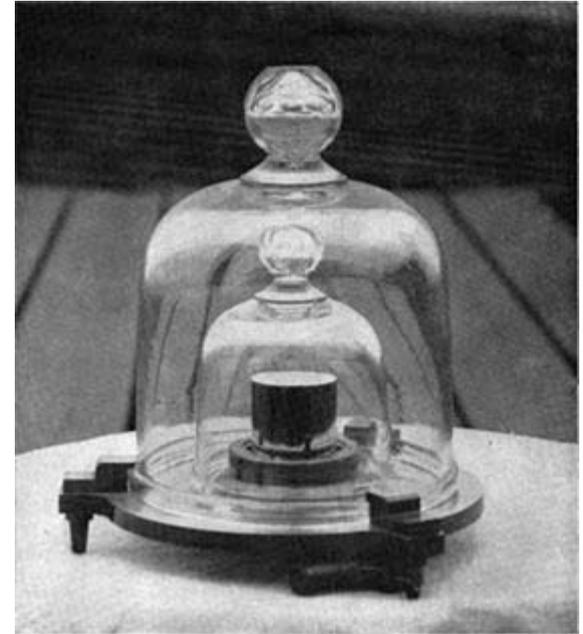
Outros padrões nacionais podem ser comparados com este padrão através de balanças de braços iguais (balanças analíticas) com uma precisão de uma parte em  $10^7$ , para massas de 1 kg.
