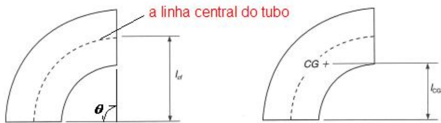
Figura 5-1 Representação de uma curva de tubo em 90° e seu centro de gravidade (à direita).
