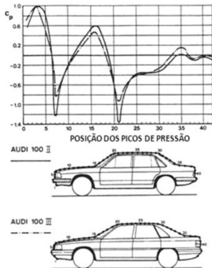
FIGURA 4.19 - POSIÇÃO DOS PICOS DE PRESSÃO DO AUDI 100: 100 II, C_A = 0,42 ; 100 III, C_A=0,30 , fonte: Ref[5]
