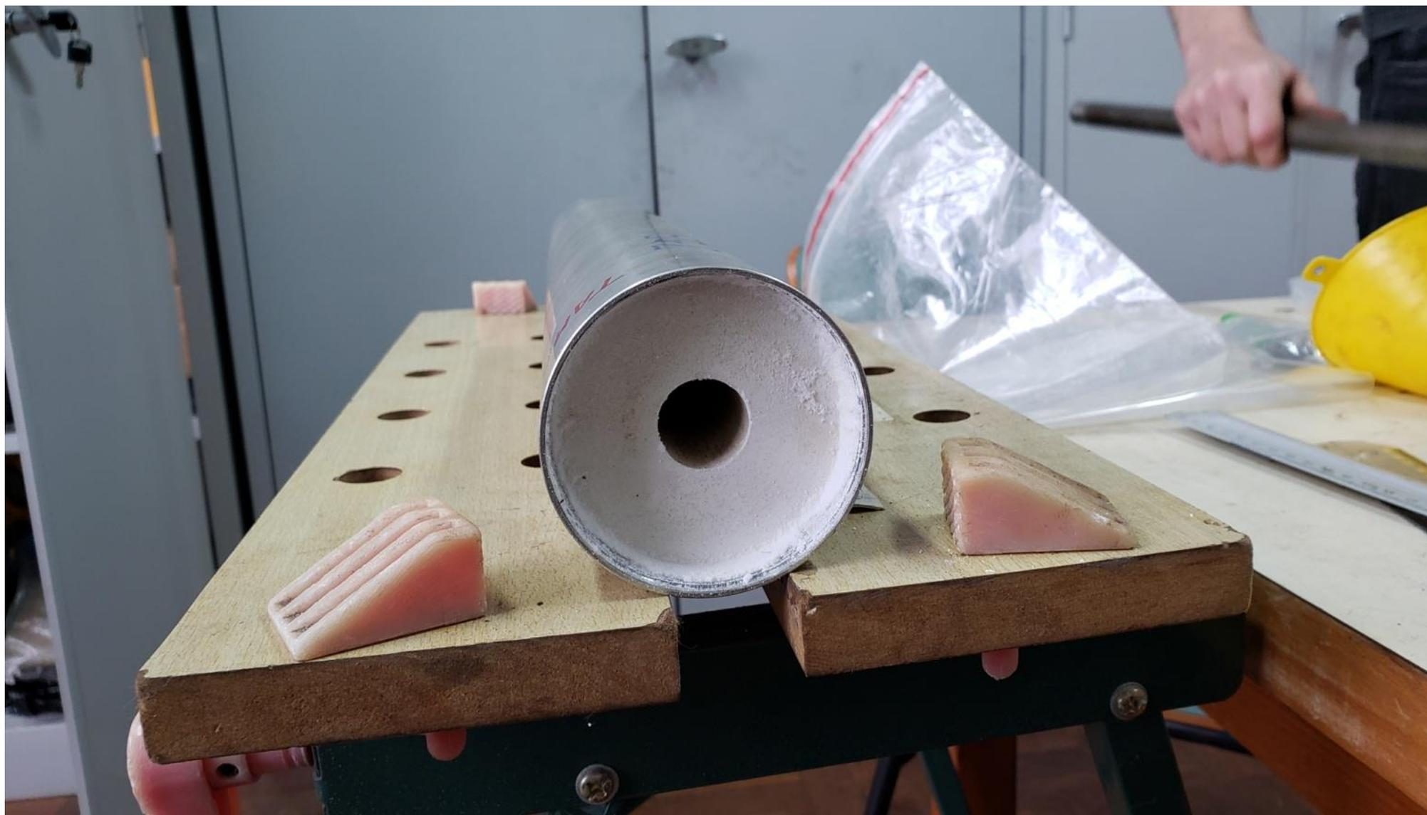
**Tubo-motor Saturno-Gama após a prensagem do KNSu;
