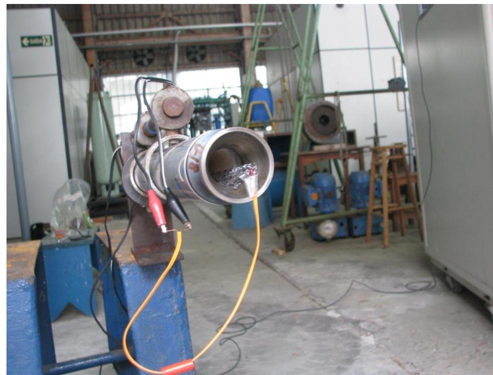
Motor-foguete Urano-Beta preparado para teste com ignitor e squib (laranja) conectados
