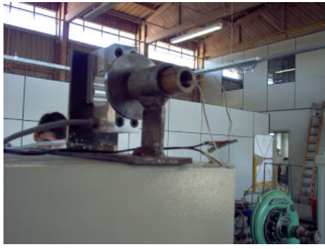
Um motor SE pronto para teste com o ignitor instalado.
