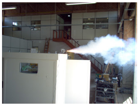
Motor do tipo SE (Saber Eletrônica) durante a queima do seu propelente.
