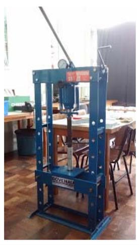
**Prensa BOVENAU preparada para compactar o propelente em um motor.**
