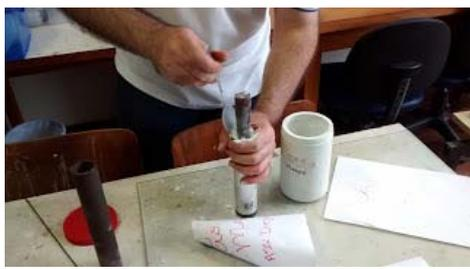
**Carregamento do propelente no motor antes da prensagem.**
