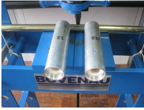
Vista externa de dois motores após a prensagem do propelente.
