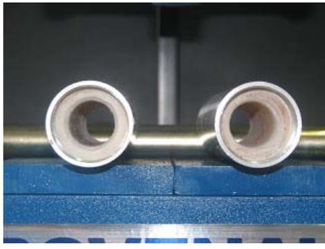
Vista interna de dois motores com o propelente prensado.
