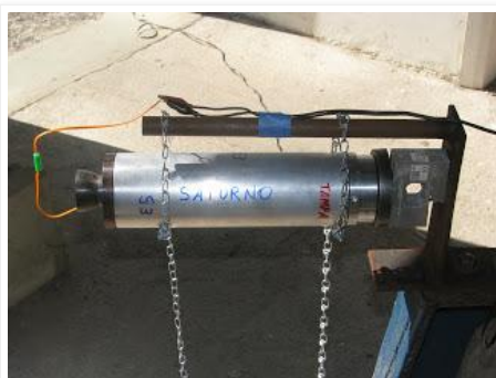
O motor-foguete experimental Saturno preparado para teste estático. Motor a propelente sólido (KNSu) da classe I. GFCS-UFPR/Gralha Azul. Foto: Diego Fernando Moro.
