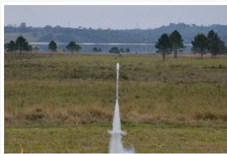
O MF Urano/Paraná-XIV decolando em Piraquara (PR) no dia 6 Ago 2018. Com um motor da classe H, ele atingiu 922 metros de apogeu e 860 km/h.
