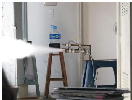
Motor-foguete experimental com tubeira plug durante o seu teste estático
