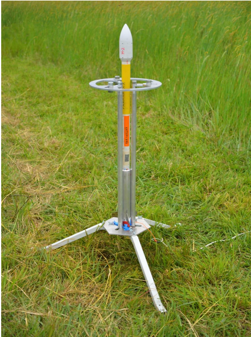
Propelente: KNSu = 35% açúcar + 65% fertilizante de nitrato de potássio
