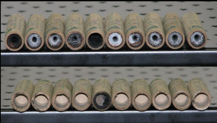
Motores D20-0 após os testes de curva de empuxo
