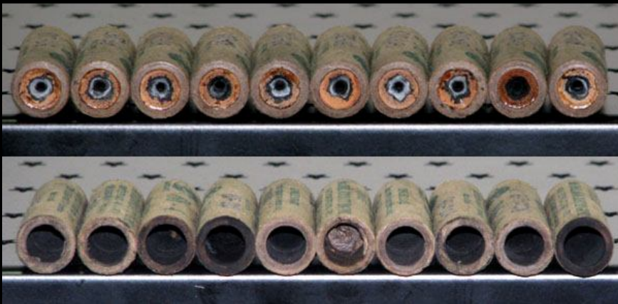
Motores B6-4 após os testes de curva de empuxo
