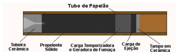
Visando permitir a recuperação dos espaçomodelos, os propulsores são dotados de uma carga de ejeção de pára-quadras ou fita, cujo acionamento é controlado por uma carga pirotécnica temporizadora que tem a finalidade, também, de gerar fumaça para permitir o rastreamento ótico de ascensão do espaçomodelo. Por último, para contenção da carga de ejeção, existe uma camada de cerâmica prensada, que se desfaz pela pressurização ocorrida no momento da queima dessa carga.
