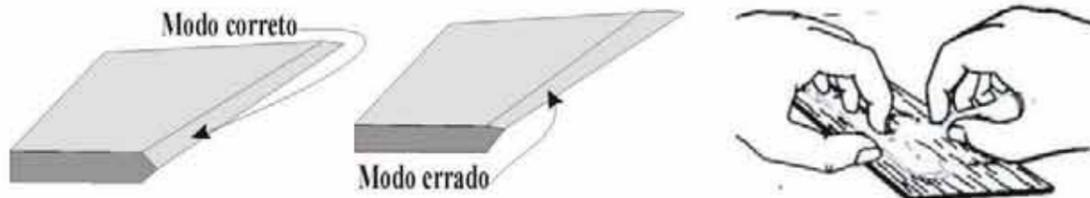
Após as empenas estarem bem lixadas, aplique a película de adesivo que acompanha o kit. Esta película deverá ser aplicada de ambos aos lados da empena, fazendo dela um sanduiche, depois corte com uma tesourinha as rebarbas de excesso.
