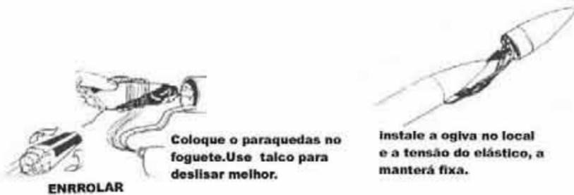
instale a ogiva no local e a tensão do elástico, a manterá fixa.
