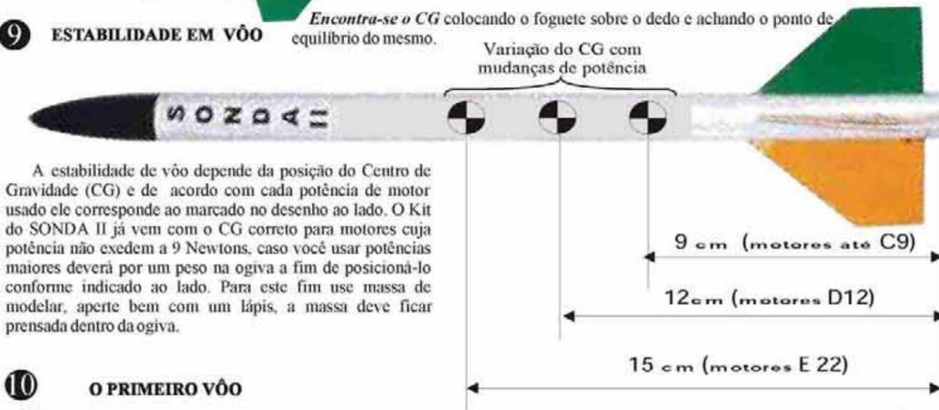
A estabilidade de vôo depende da posição do Centro de Gravidade (CG) e de acordo com cada potência de motor usado ele corresponde ao marcado no desenho ao lado. O Kit do SONDA II já vem com o CG correto para motores cuja potência não excedem a 9 Newtons, caso você usar potências maiores deverá por um peso na ogiva a fim de posicioná-lo conforme indicado ao lado. Para este fim use massa de modelar, aperte bem com um lápis, a massa deve ficar prensada dentro da ogiva.
