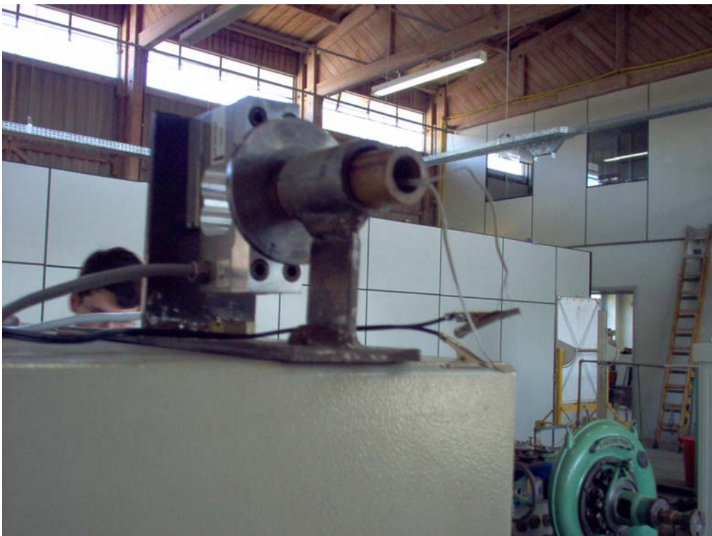
Figura 5. Foto da bancada experimental com o motor SE-1 preparado para o teste estático, já com o ignitor.
