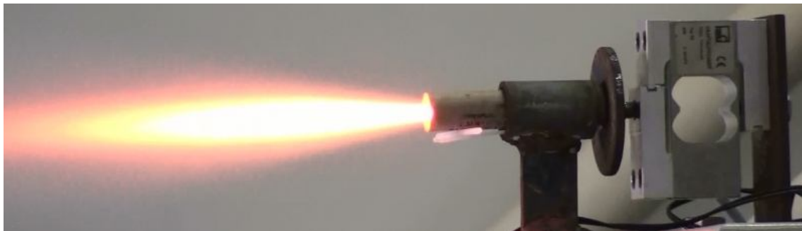
Figura 10. Foto mostrando o motor BT-80 (A6-0) durante o seu teste estático.
