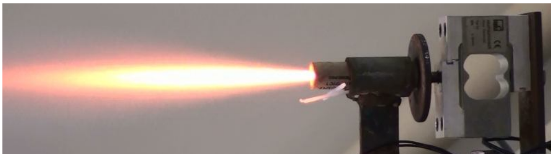
Figura 11. Foto mostrando o motor BT-90 (B6-0) durante o seu teste estático.
