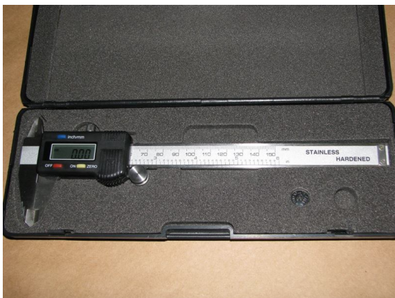
Figura 5. Fotos mostrando o paquímetro digital Lee Tools usado nas medições.
