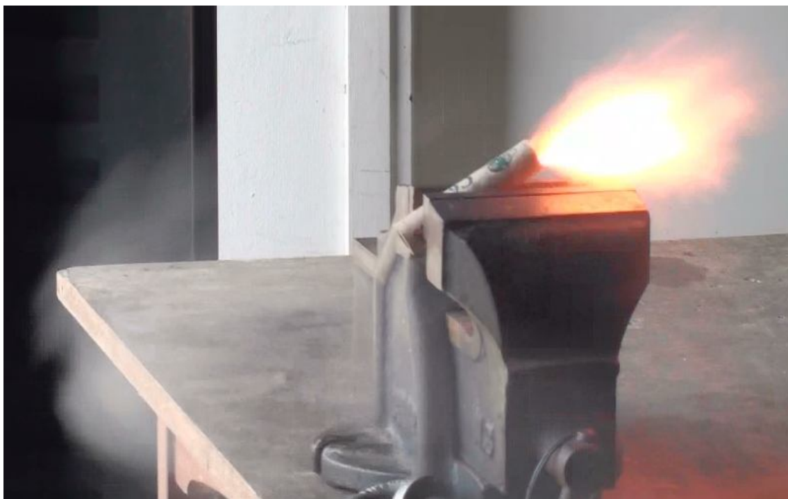
Figura 15. Foto mostrando o motor BT-123 (C6-5) durante a queima da sua carga ejetora.
