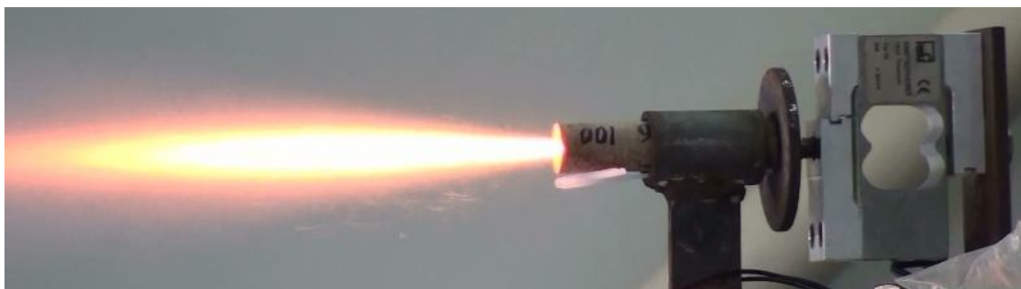
Figura 12. Foto mostrando o motor BT-100 (C6-0) durante o seu teste estático.
