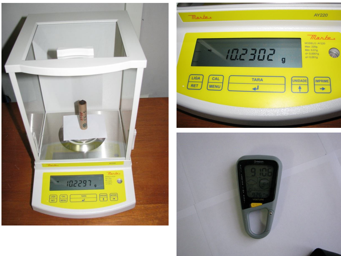
Figura 6. Fotos mostrando a balança e o medidor de temperatura e pressão usados.
