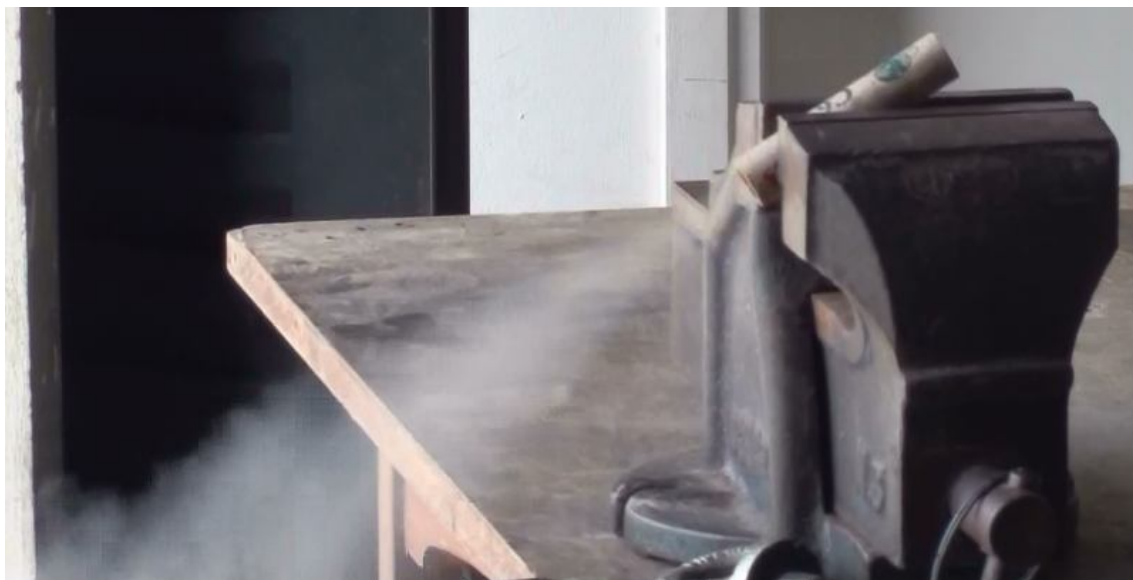
Figura 14. Foto mostrando o motor BT-123 (C6-5) durante a queima da sua carga temporizadora.
