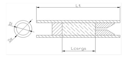
De: diâmetro externo do motor; uma medida no meio com paquímetro digital Lee Tools (resolução = 0,01 mm) em 29 Ago 2014
