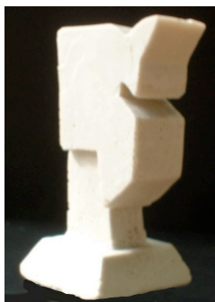
figura 7 – Resultado da moldagem em PP a 210°C
