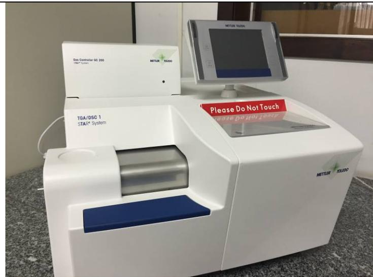
Analizador Termogravimétrico com DTA.
